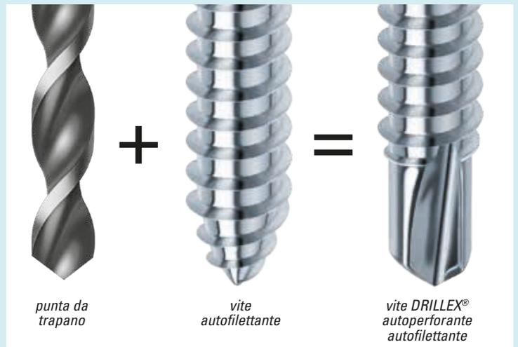
Il diametro ottimale di foratura viene ottenuto direttamente dalla vite, che poi filetta ed avvita consecutivamente.
