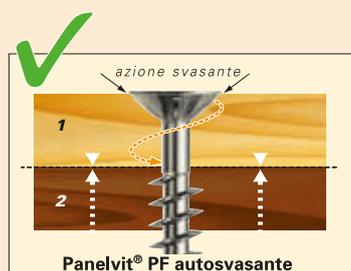
Il gambo liscio della vite ruota liberamente nella parte superiore (1). La filettatura opera sulla parte inferiore (2) avvicinandola alla prima.
