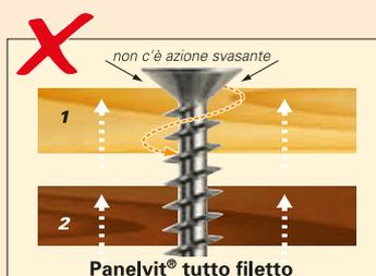
La filettatura agisce allo stesso modo sulle due parti, impedendo alla parte inferiore (2) di accostarsi alla parte superiore (1) e di ottenere il serraggio.
