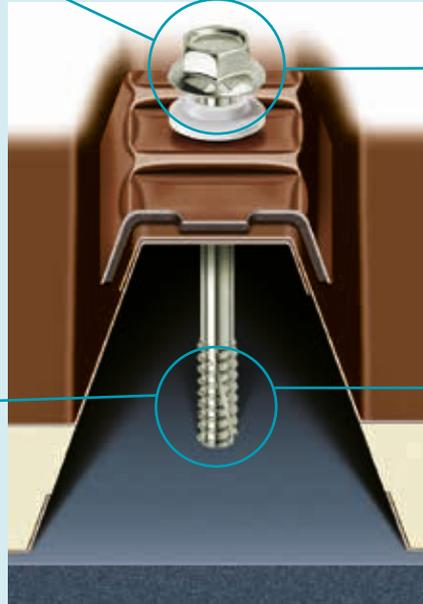
**TESTA CON CHIAVE ESAGONALE a spigoli vivi, dotata di collare cavo**, studiata per l'alloggiamento ottimale della rondella elastica di tenuta contro le infiltrazioni d'acqua.
