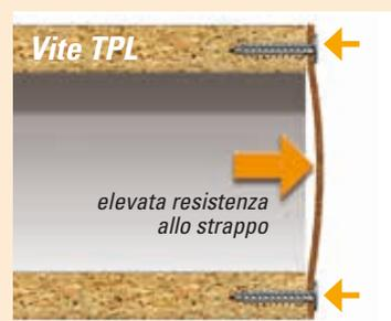
La punta ogiva, filettata fin sull'estremità, penetra nel materiale deformandolo gradualmente senza provocare fenditure ed evitando il danneggiamento dello strato laminato di finitura.
