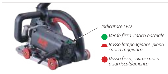
Indicatore led per monitorare l'utilizzo del motore
