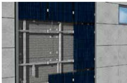
Sottostruttura montanti e trasversi
