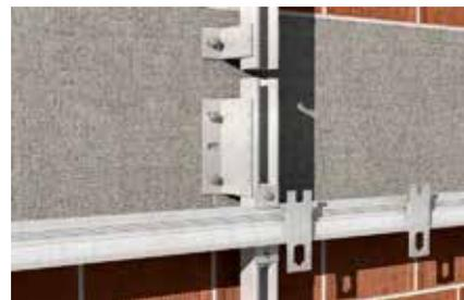
Dettaglio: fissaggio profilo VP alla staffa
